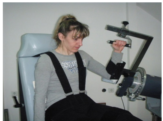
Εικόνα 2. Θέση και σταθεροποίηση της δοκιμαζόμενης με ιμάντες στο ισοκινητικό δυναμόμετρο.
